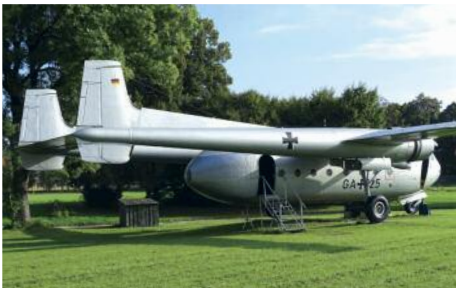
Heckansicht der »Nora«. Das Rumpffheck lässt sich – wie bei Scheunentoren – nach links und rechts wegklappen
