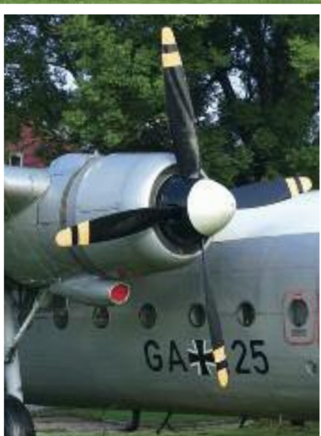
Galten als besonders zuverlässig: SNECMA Hercules 739/759 mit Verstellpropeller. Die beiden gelben Streifen an den Blattspitzen verraten, dass eine Schubumkehr möglich ist
